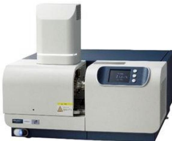
2. ИК Фурье-спектрометр (в комплекте с компьютером) – прибор, позволяющий регистрировать ИК-спектр образца, который представляет собой «отпечаток пальцев», поскольку не существует двух соединений с одинаковыми инфракрасными спектрами. Прибор может также работать в дополнение к дериватографу. Студент (исследователь) сможет применить прибор для идентификации неизвестных материалов, качественного и количественного анализа компонентов исследуемого образца.
